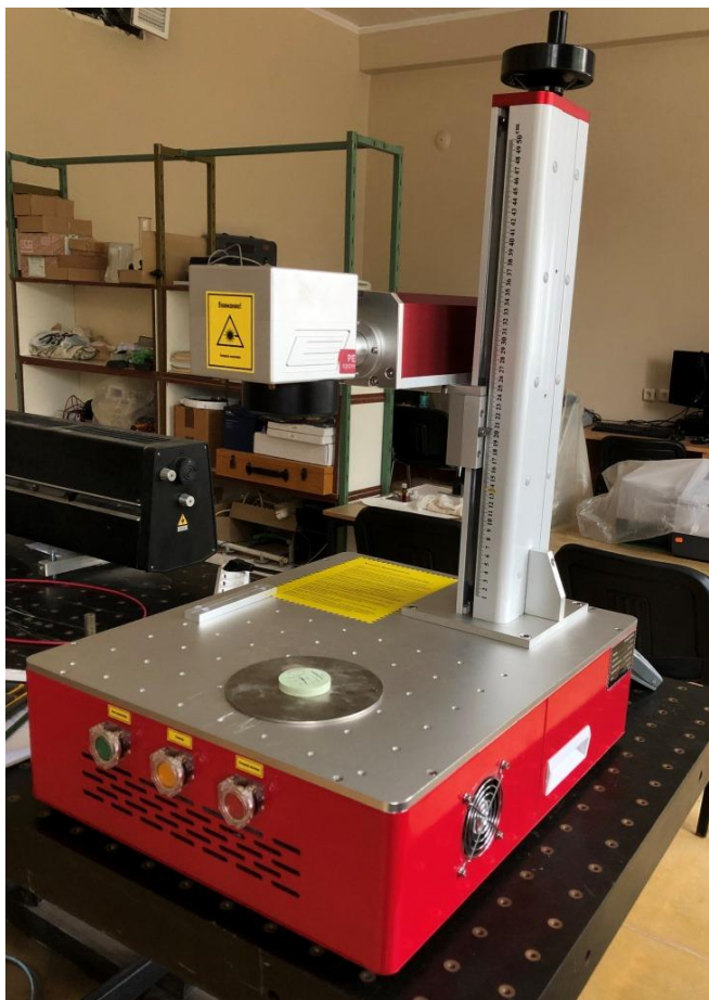
Волоконный лазер с иттербиевым оптоволоконным источником, 1.06 мкм, 20Вт
