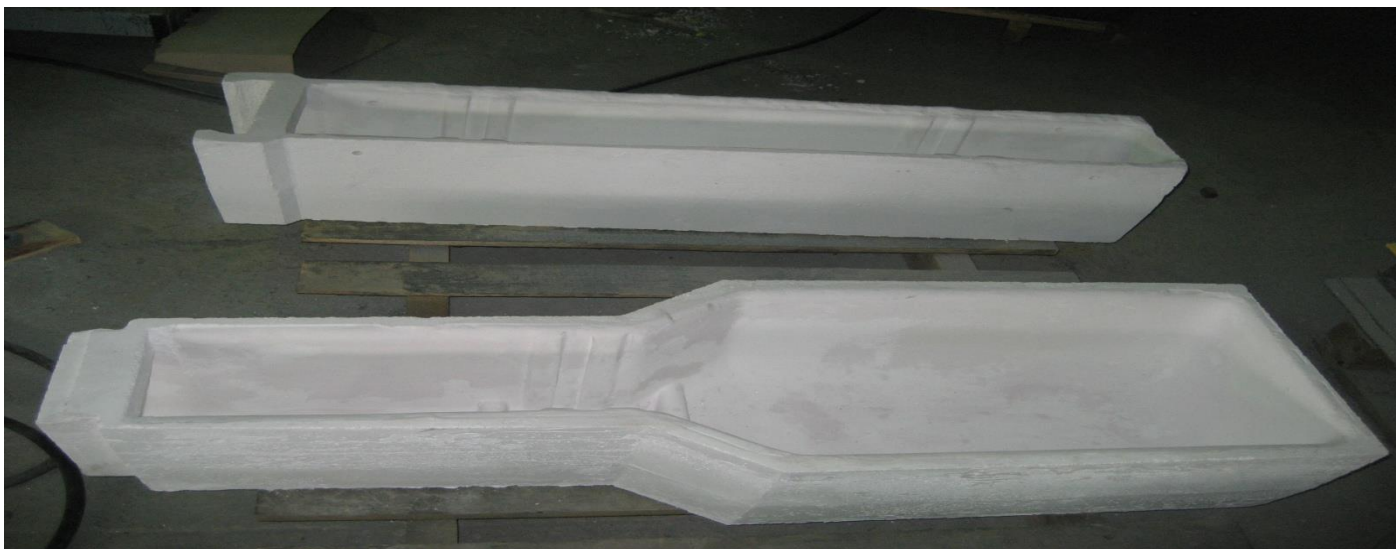
Литниковая система плавильной вакуумной печи «CONSARC»(Великобритания), Ступинская металлургическая компания
