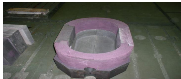
печь плавки цокольного стекла (ОАО «Калашниковский электроламповый завод, г. Владимир)
