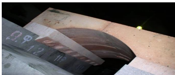
стендовая сборка верхнего и нижнего строения печи плавки базальта (ОАО «КСМС», Казахстан, г. Алма-Аты)
