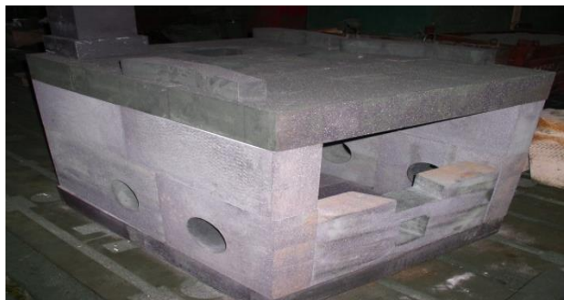
печь плавки базальта для получения базальтовой чешуи (ЗАО «Базальтопластик», г. Нарофоминск)
