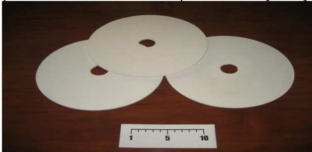
дисковый фильтрующий элемент из пористой проницаемой керамики
